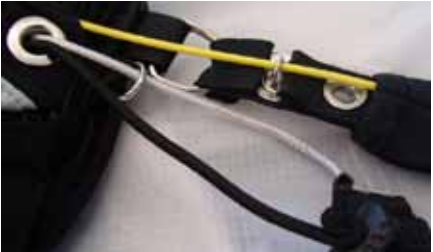
>> Sistema de separação automática do apoio de pé e do acelerador quando acionado o paraquedas de emergência.
